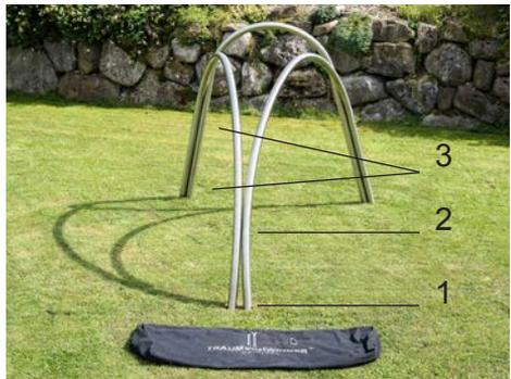
Fädeln Sie den zweiten Bogen in die gebogene Gewindestange ein und verschrauben Sie ihn. Alle weiteren M8 Gewindestangen verschrauben Sie am einfachsten in nummerierter Reihenfolge.
